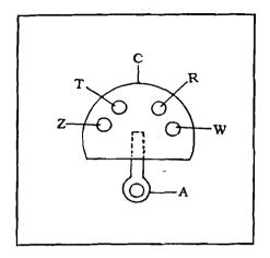
FEED PUMP PORTS IN FEED PUMP DISC
